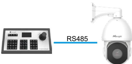
Die Kamera verfügt über eine RS485 Schnittstelle. So können Sie die Kamera mit einem RS485-Controller über RS485 mit PELCO-D Protokoll steuern.
