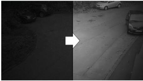
Bei schlechten Lichtbedingungen, zum Beispiel nachts, schaltet die Kamera automatisch in den Schwarz/Weiß-Betrieb um. Die Sicht wird zusätzlich durch die integrierte Infrarotbeleuchtung unterstützt. Die Kamera besitzt einen eingebauten Infrarot-Sperrfilter (IR-Cut-Filter). Damit werden störende Einflüsse der IR-Strahlung auf die Abbildungsqualität des Sensors vermieden.
